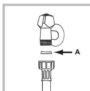
1. Ставите заптивку A између црева за довод воде и славине са хладном водом и навијте је с дужине навоја (види слику). Пре затезања пустите воду да истече.
